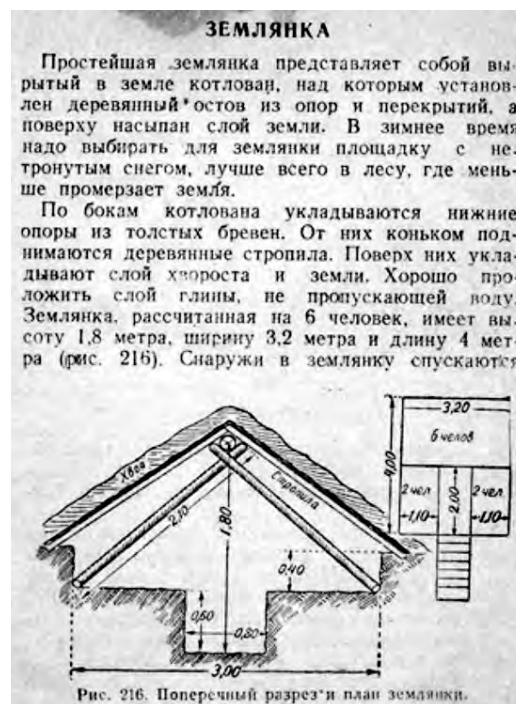
Abb. 18: Sowjetische Schemazeichnung zum Bau einer Semljanka [Anm. 2]
